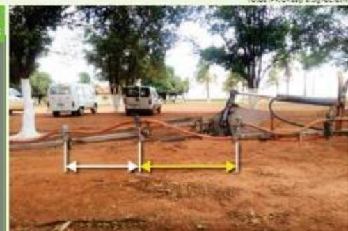
Espaçamentos de bicos irregulares na barra de pulverização. Item em "não conformidade"
