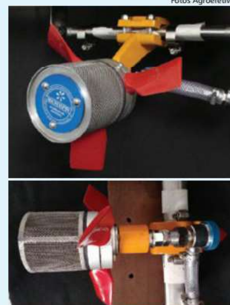
Atomizador rotativo com mecanismo de ajuste do ângulo da pá da hélice
