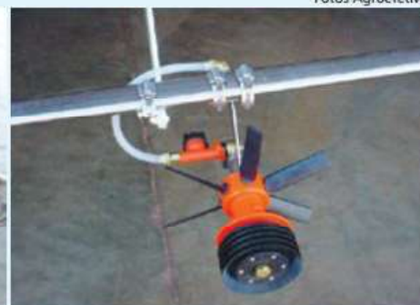
Exemplos de atomizadores: (esquerda) atomizador rotativo de tela, (direita) atomizador rotativo de disco
