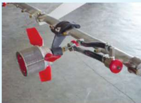
Exemplos de atomizadores: (esquerda) atomizador rotativo de tela, (direita) atomizador rotativo de disco
