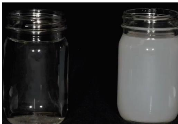
Figura 9. O frasco à esquerda mostra o glyphosate dissolvido em água destilada. Quando a água contém altos níveis de minerais na água dura, as moléculas de glyphosate podem se ligar aos minerais não ficando disponíveis como herbicida, conforme mostrado pela água turva (direita). Fonte: Whitford et al. (2018).
