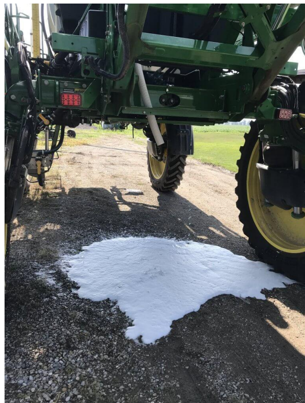
Figura 8. Derramamento de espuma do tanque de pulverização. Fonte: Deveau (2020b).
