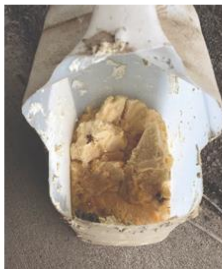
Figura 10. Sedimentos retirados do sistema de injeção do pulverizador quando glyphosate e 2,4-D foram misturados sem ter pelo menos 50% de água no tanque. O tanque foi fácil de limpar, mas algumas linhas de injeção tiveram que ser substituídos. Fonte: Whitford et al. (2018).
