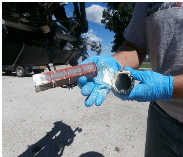
Figura 6. Filtros entupidos com sedimentos formados na calda. Fonte: Whitford et al. (2018).
