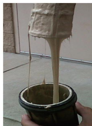
Figura 5. Viscosidade da calda obstruindo filtros. Fonte: Whitford et al. (2018).
