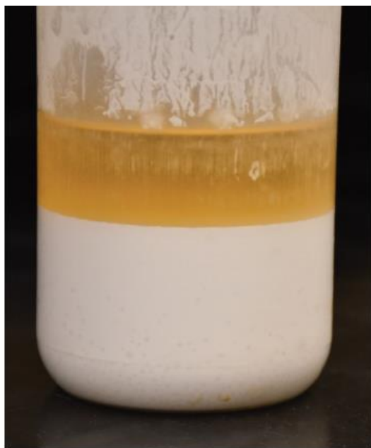
Figura 7. Incompatibilidade física de produtos ocasionando a separação de fases da mistura. Fonte: Whitford et al. (2018).
